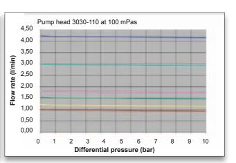
■ 4000 RPM | ■ 2830 RPM | ■ 1725 RPM | ■ 1450 RPM | ■ 1150 RPM | ■ 950 RPM
