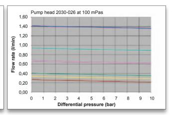
■ 6000 RPM | ■ 4000 RPM | ■ 2830 RPM | ■ 1725 RPM | ■ 1450 RPM | ■ 1150 RPM
