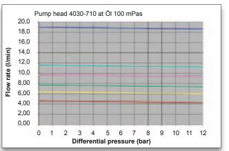
■ 2830 RPM | ■ 1725 RPM | ■ 1450 RPM | ■ 1150 RPM | ■ 950 RPM | ■ 690 RPM
